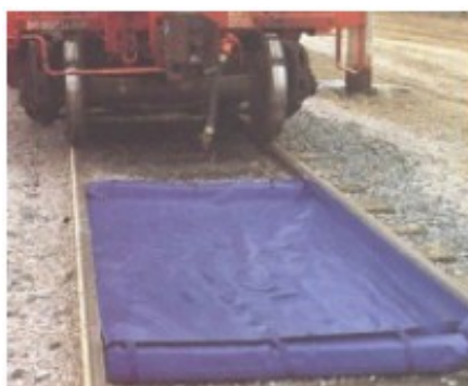
3. kép Olajfogó medence (Hunyár Á. at. all. 2002)
